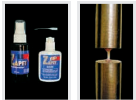
Figura 12 - Adesivo utilizado para fixação dos palitos ao dispositivo.
