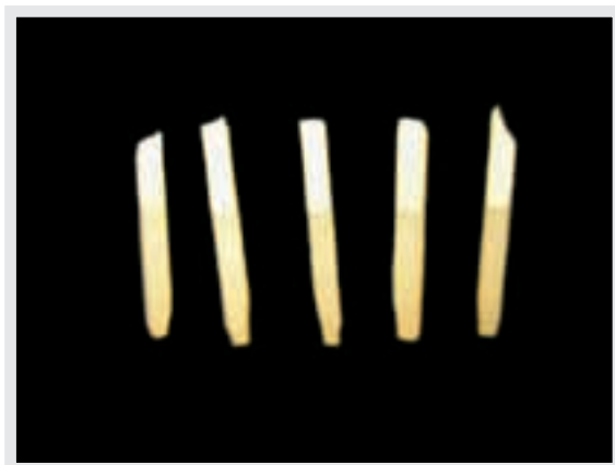
Figura 11 - Espécimes em forma de palitos com área de colagem de \pm 1\text{mm}^2 .
