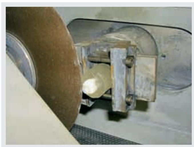
Figura 2 - Dente posicionado na máquina de cortes para remoção do terço oclusal.
