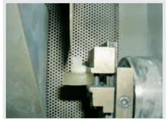
Figura 10 - Conjunto dente/adesivo/resina composta posicionado para realização dos cortes.
